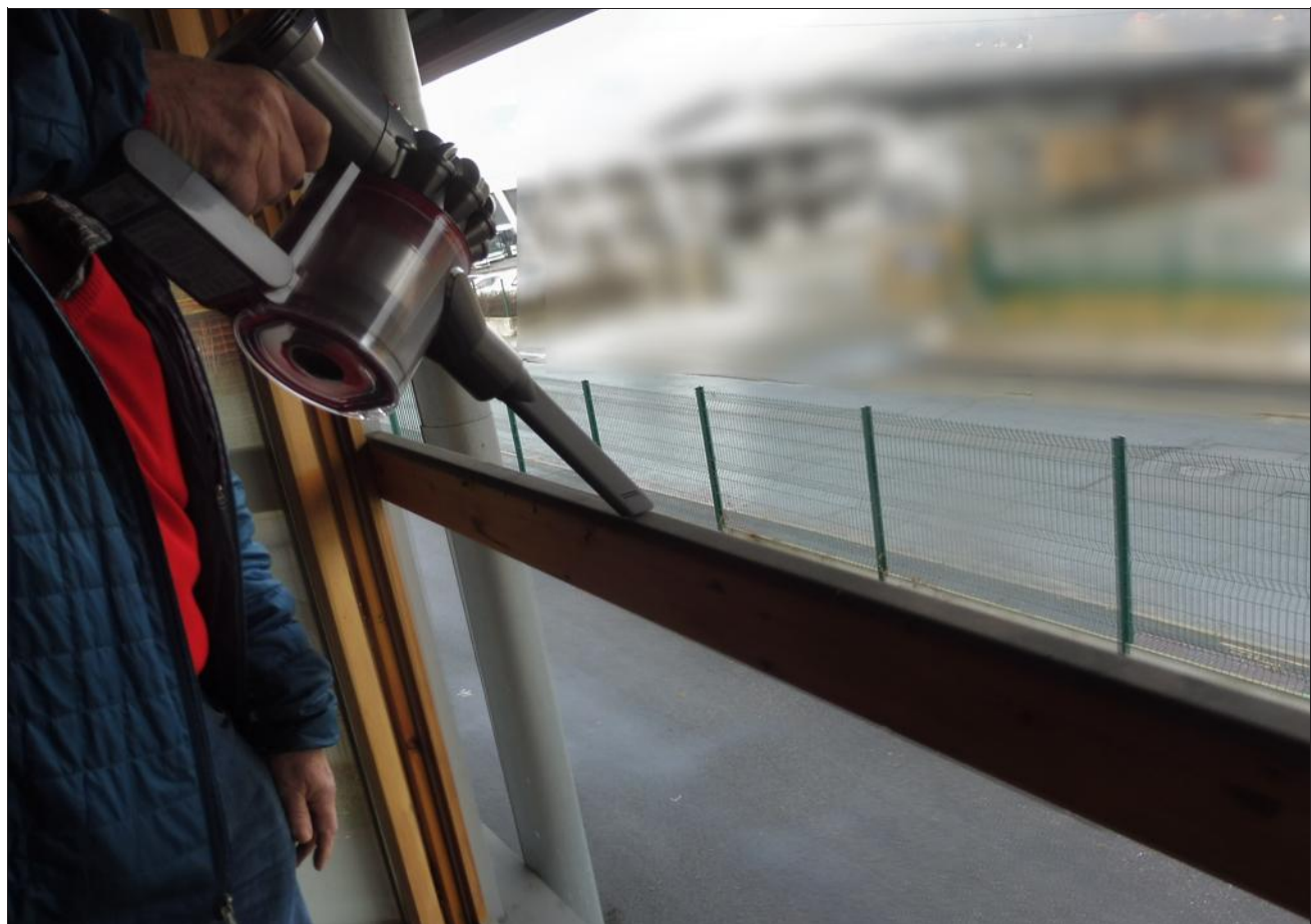
Les poussières ont été prélevées à l'aide d'un aspirateur sur le rebord d'une fenêtre n'ayant jamais été nettoyé. Photo DR
